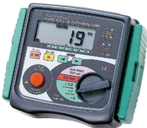
Le K5406A est un instrument qui sert à contrôler des disjoncteurs différentiels. Le temps de déclenchement peut aisément être mesuré à la prise de courant. Cet instrument est doté d'un circuit commandé par microprocesseur qui fonctionne indépendamment de la tension, ce qui assure des mesures très précises.
