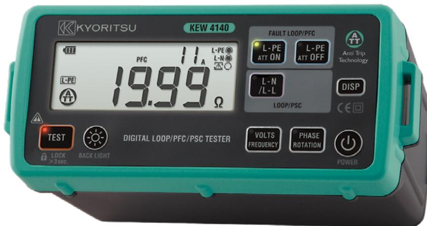
Le K4140 est équipé d'une technologie anti-déclenchement (ATT) qui contourne les différentiels de manière électronique pendant des tests d'impédance de boucle. Ceci fait gagner du temps et de l'argent puisqu'il n'est pas nécessaire de retirer le différentiel du circuit pendant le test; c'est en plus une procédure beaucoup plus sûre. Lorsque la fonction ATT est activée, un courant de test de 15mA ou moins est appliqué entre la ligne et la terre.
