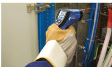
Il est toujours plus sûr de prendre des mesures de température sans contact avec les conducteurs. Cela réduit considérablement le risque d'accident
