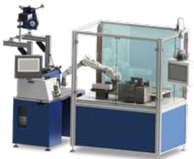
Integration einer vorhandenen Wickelmaschine, unsere innovative Lösung bildet die Arbeitsschritte eines Mitarbeiters präzise ab und automatisiert sie nahtlos. Vom Bestücken der Wickelmaschine bis zum Testen der Spule und anschließender Sortierung in i.O. und n.i.O. Teile – jeder Schritt wird effizient und zuverlässig ausgeführt.
