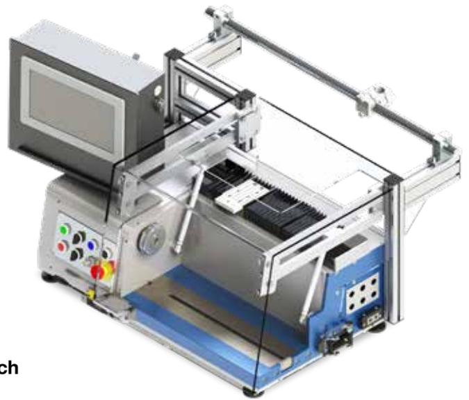
**Optional Öffnen des Schutzschields nach oben oder seitlich**
