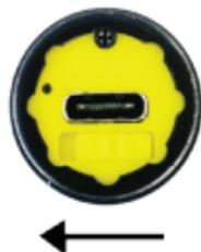
**NOTA:** A câmara só tem a proteção IP 67 com a tampa enroscada.
