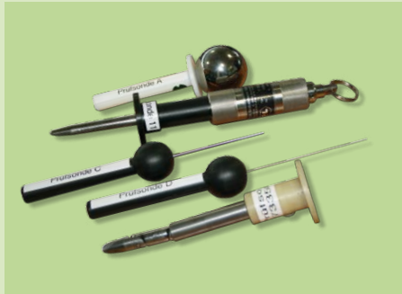
Prüfsonden nach DIN EN 60529
