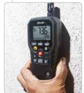
El modelo FLIR MR77 integra un sensor de humedad sin clavija y una sonda de clavija con cable.
