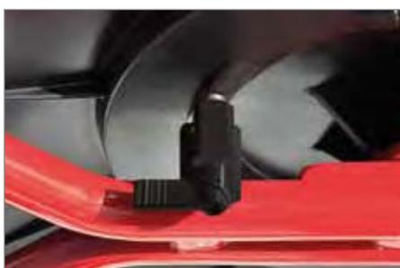
Massive Bremse mit Feststellmechanismus
