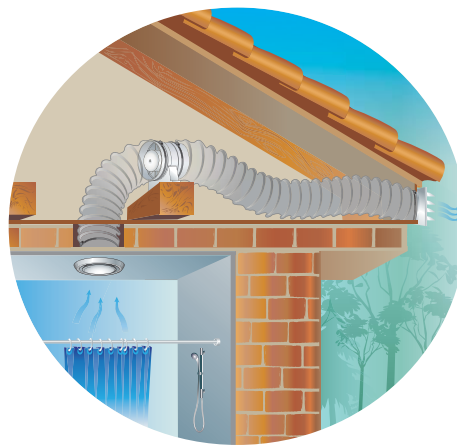
VKOk fan cottage ventilation example
