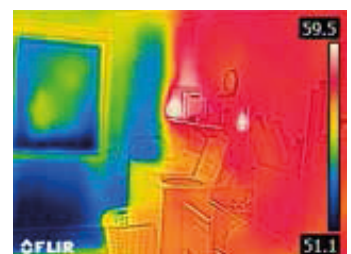
Pared exterior sin aislar.
