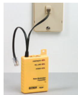
El transmisor inyecta una señal trazable en los cables, comprueba las líneas telefónicas y comprueba la continuidad.
